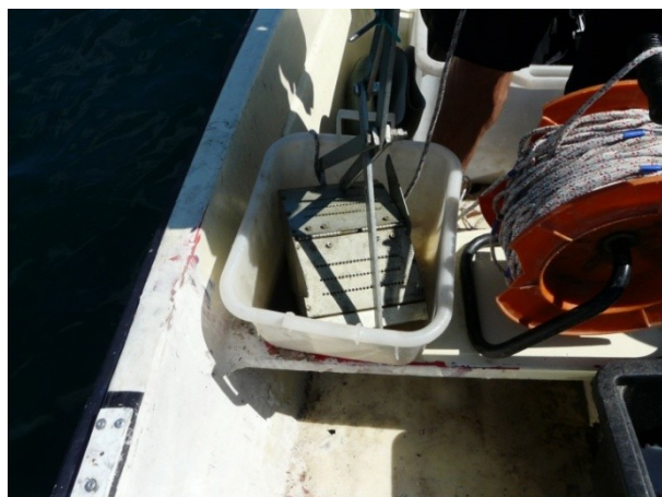
Figura 7. Draga Ponar utilizzata per il campionamento della componente macrobentonica e svuotamento della draga durante il campionamento
