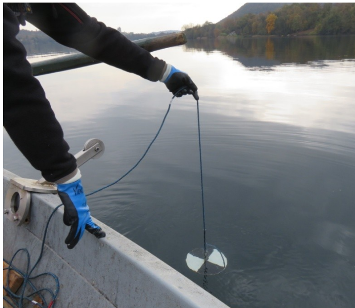
Figura 1. misurazione della trasparenza con il disco di Secchi
