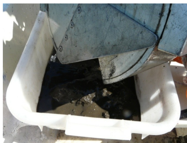
Figura 7. Draga Ponar utilizzata per il campionamento della componente macrobentonica e svuotamento della draga durante il campionamento
